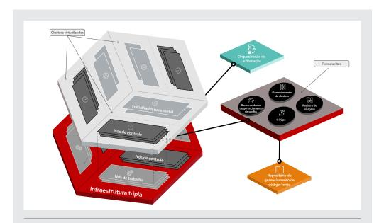
Figura 1. Representação visual da arquitetura do Red Hat OpenShift em escala. O Red Hat Ansible Automation Platform se conecta ao control plane, ao restante dos clusters e a ferramentas como o repositório de gerenciamento de código-fonte, banco de dados de controle de configurações e registros de imagens.
