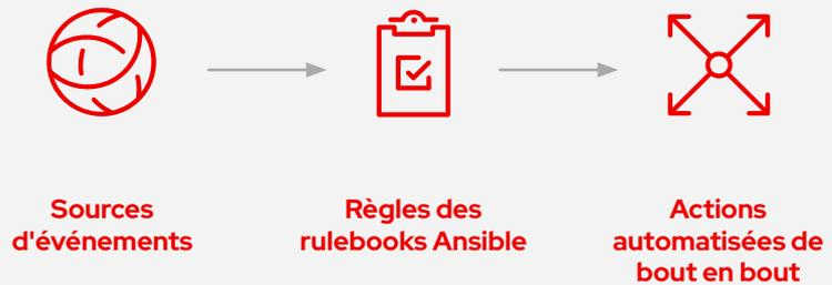
Figure 1 : fonctionnement de la solution Event-Driven Ansible avec des sources, des règles contenues dans des rulebooks et des actions
