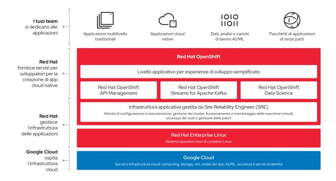
Figura 1. Red Hat gestisce l'infrastruttura sottostante e la piattaforma applicativa, consentendoti di dare la priorità allo sviluppo e al deployment delle applicazioni.
